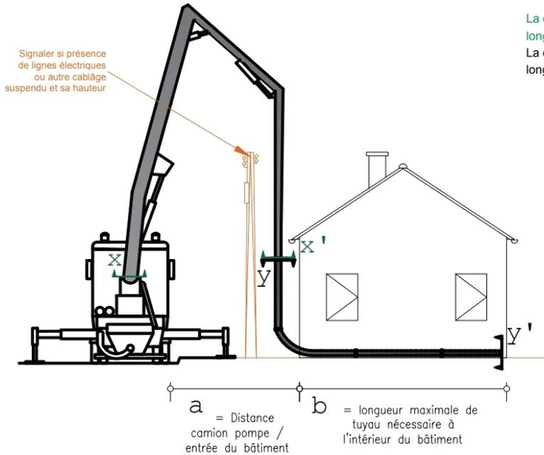
Pour déterminer la hauteur de la flèche, il faut tenir compte de la distance **a** et de la présence éventuelle de lignes électriques ou autre câblage suspendu.
