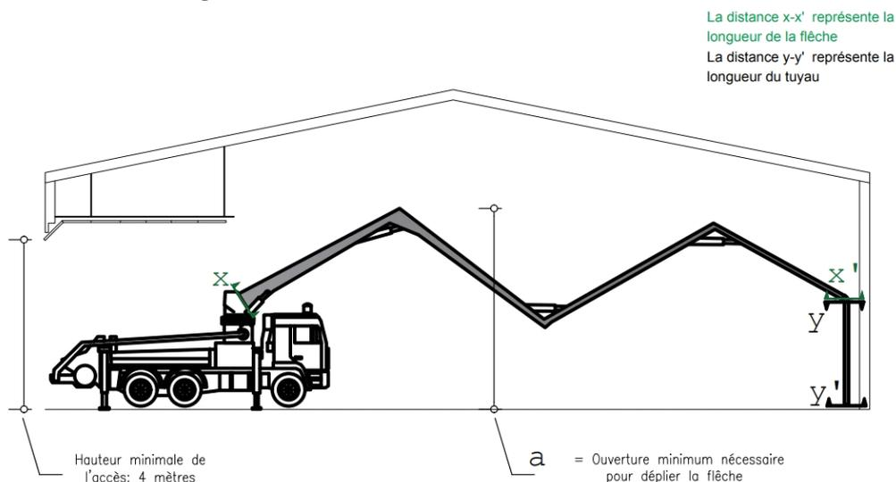
L'ouverture d'accès doit être au minimum de 4 mètres de haut.
